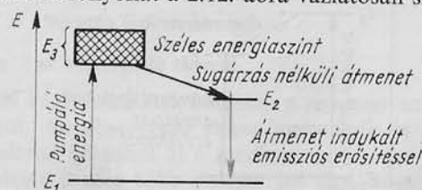
2.12. ábra. Egy széles energiaszintű háromnívós rendszer a pumpáló energia jobb kihasználására
