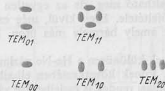
3.16. ábra. Laserrezonátor néhány módusa
