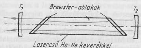
3.15. ábra. Gázasercső konfokális rezonátorban sugármenettel, vázlatosan ábrázolva
