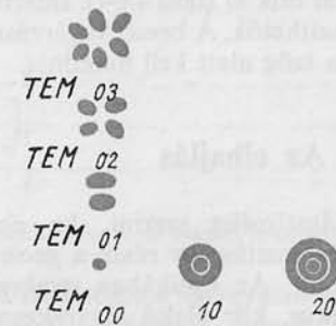
4.15b ábra. r -, \varphi -szimmetriájú rezonátor-módusok
